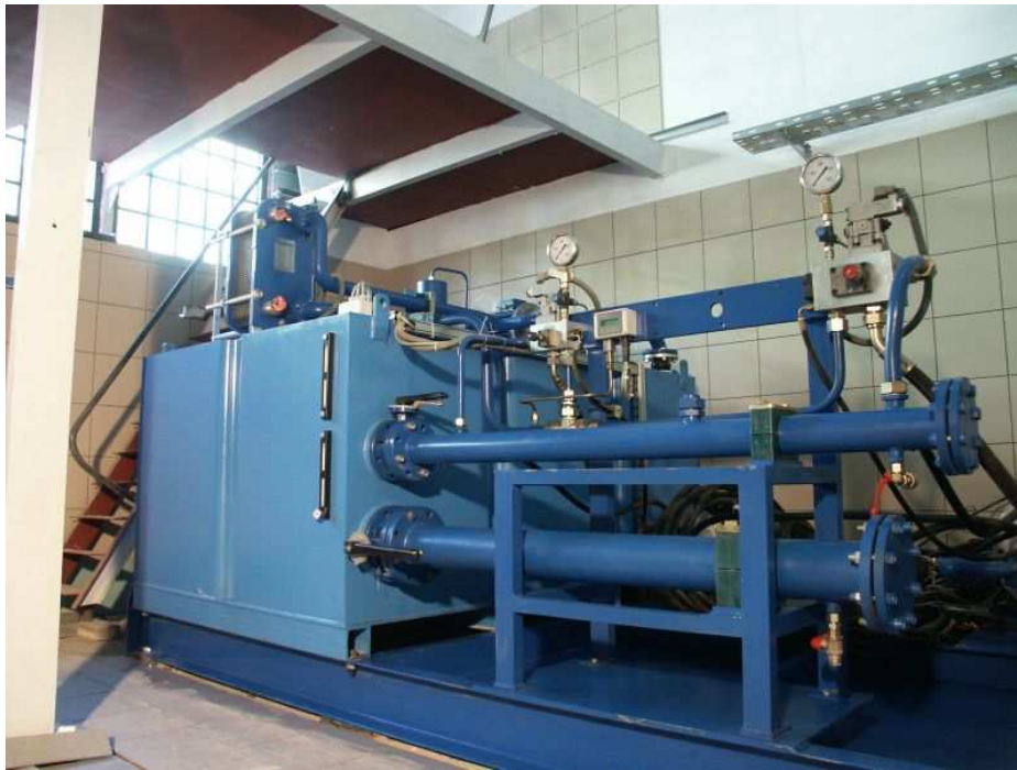
Rys. 2. Urządzenie hydrauliczne do badań zmęczeniowych zbiorników.
