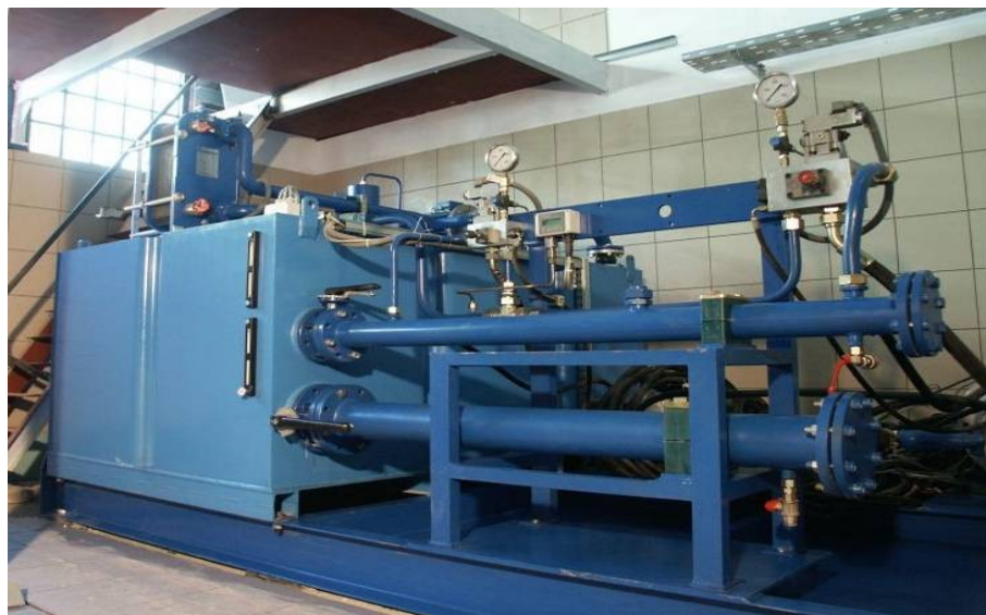
Pulsator hydrauliczny do badań cyklicznych
