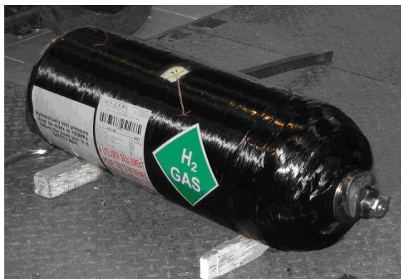
Wysokociśnieniowe zbiorniki kompozytowe do przechowywania H 2 - typ IV
