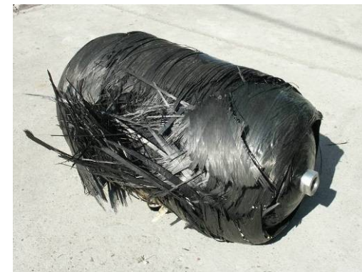
Zbiornik do CNG o nominalnym ciśnieniu pracy 350 bar - typ III
