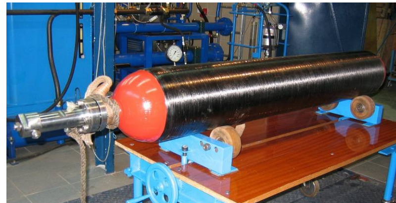
Zbiornik do przechowywania H 2 firmy Faber o nominalnym ciśnieniu pracy 700 bar - typ II
