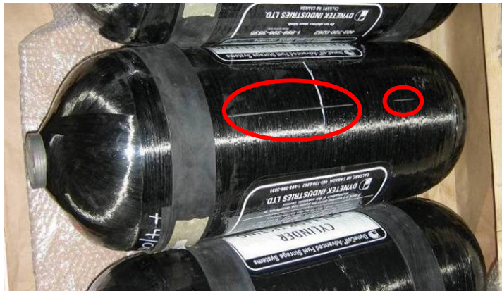
Uszkodzony wstępnie zbiornik oraz rozmieszczenie światłowodowych siatek Bragga (FBG) na zbiorniku
