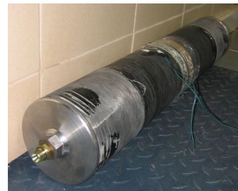
Wysokociśnieniowe zbiorniki kompozytowe do przechowywania H 2 - typ IV
