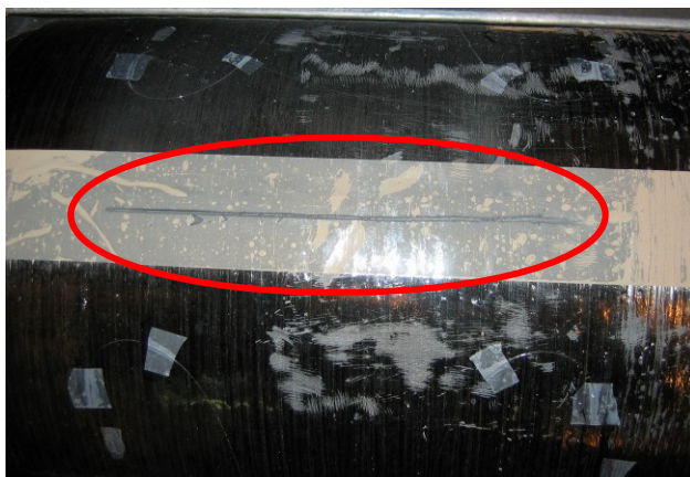
Lokalne odkształcenia zbiornika z defektem w zakresie ciśnień od 0 do 200 bar
