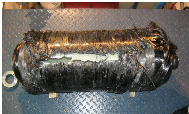
Wysokociśnieniowe zbiorniki kompozytowe do przechowywania H 2 - typ IV
